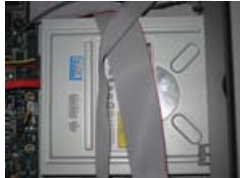
1.1. Ábra: A DVD-író csatlakoztatása
